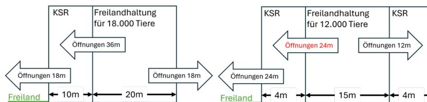
Abb. 1: Skizze Auslauföffnungen / Zugänge Stall & KSR
